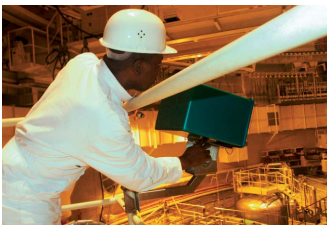
Pracovník MAAE kontroluje kameru na reaktorovém sále JE Temelín. Ta sleduje a do Vídně nepřetržitě posílá obrázky na reaktor, aby nemohlo dojít k neoprávněné manipulaci s jaderným materiálem.
