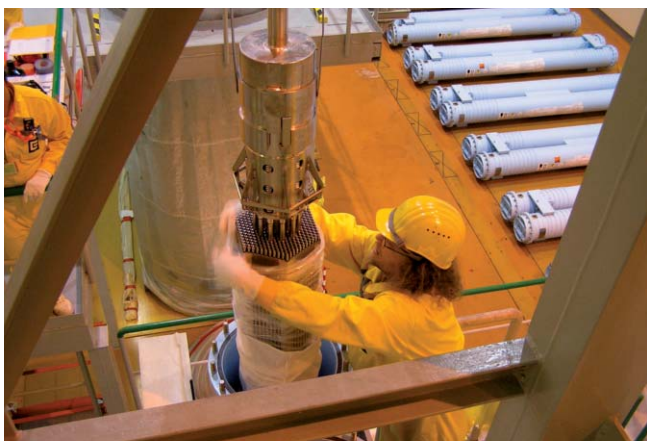
Pohled do skladu čerstvého paliva při vybalování ruského jaderného paliva pro temelínské reaktory
