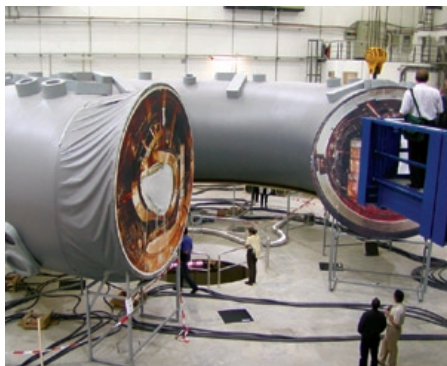
Maketa komory budoucího největšího stelarátoru na světě – Wendelstein W7-X
