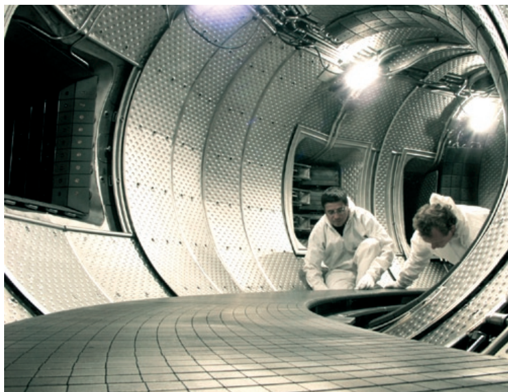
Toroidální limiter umožnil francouzskému supravodivému tokamaku Tore Supra odvod rekordních 1 GJ tepla v jednom výboji trvajícím 6:30 minut.
