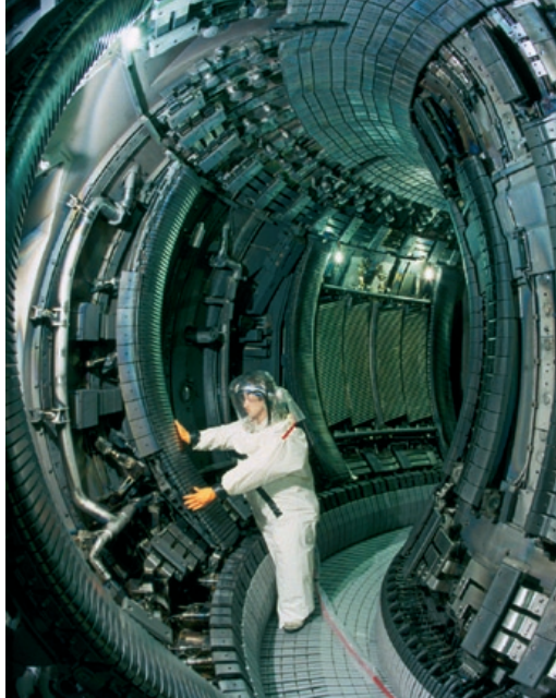
Magnetické udržení – komora největšího tokamaku na světě JET v anglickém Culhamu. Magnetické pole tvoří cívky vně komory a proud uvnitř komory.
