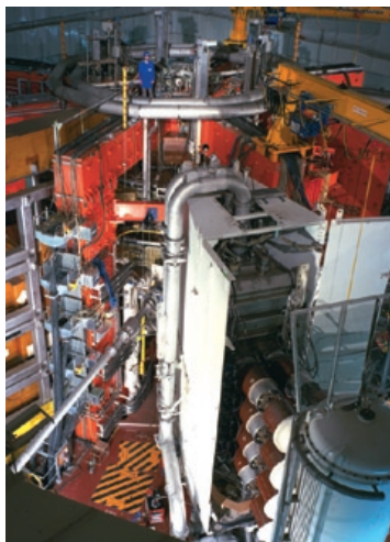
Zařízení pro vstřik svazků neutrálních atomů na tokamaku JET – na obrázku vpravo dole
