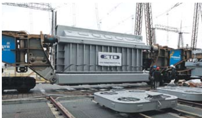
Do Jaderné elektrárny Dukovany jsou transformátory přiváženy na speciálním železničním podvozku.
