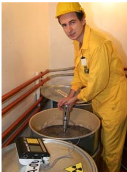
Pracovník firmy ALLDECO kontroluje pevnost matrice SIAL.
