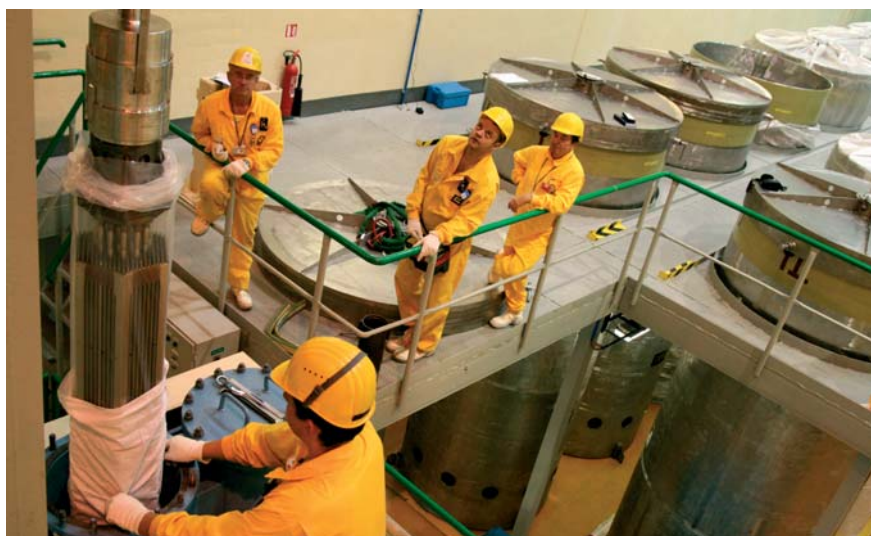
Vyjmutí imitátoru paliva z přepravního kontejneru. Fotografováno ve skladu čerstvého paliva JE Temelín.
