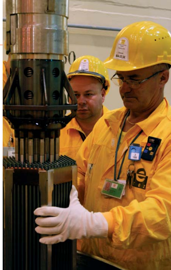
Zdeněk Majzlík usazuje imitátor paliva TVEL do zásobníku ve skladu čerstvého paliva.
