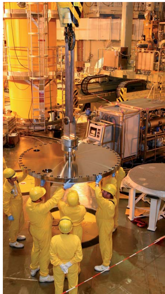
Praconíci elektrárny spolu s německými technikami připravují sekundární víko na uzavření zaplněného kontejneru CASTOR.
