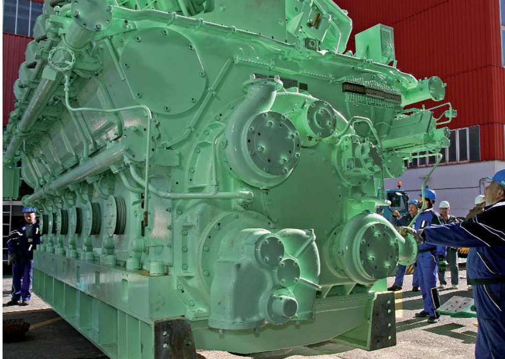
Osm takových dieselgenerátorů má Temelín k dispozici jako nouzový zdroj elektřiny pro své bloky.
