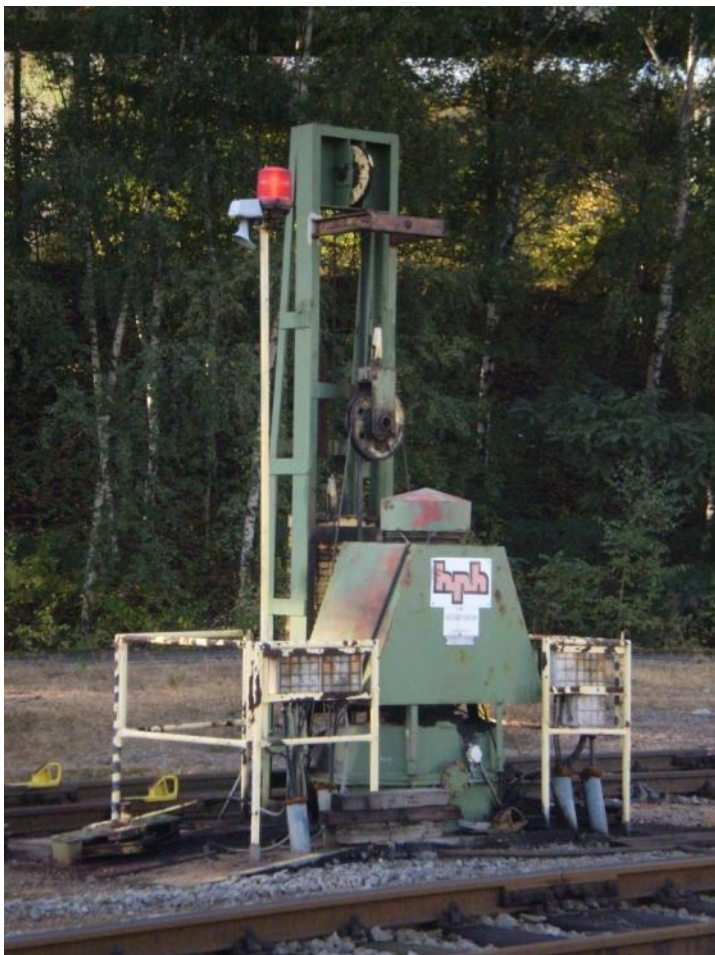
Toto zařízení automaticky pohání prázdné vagóny
