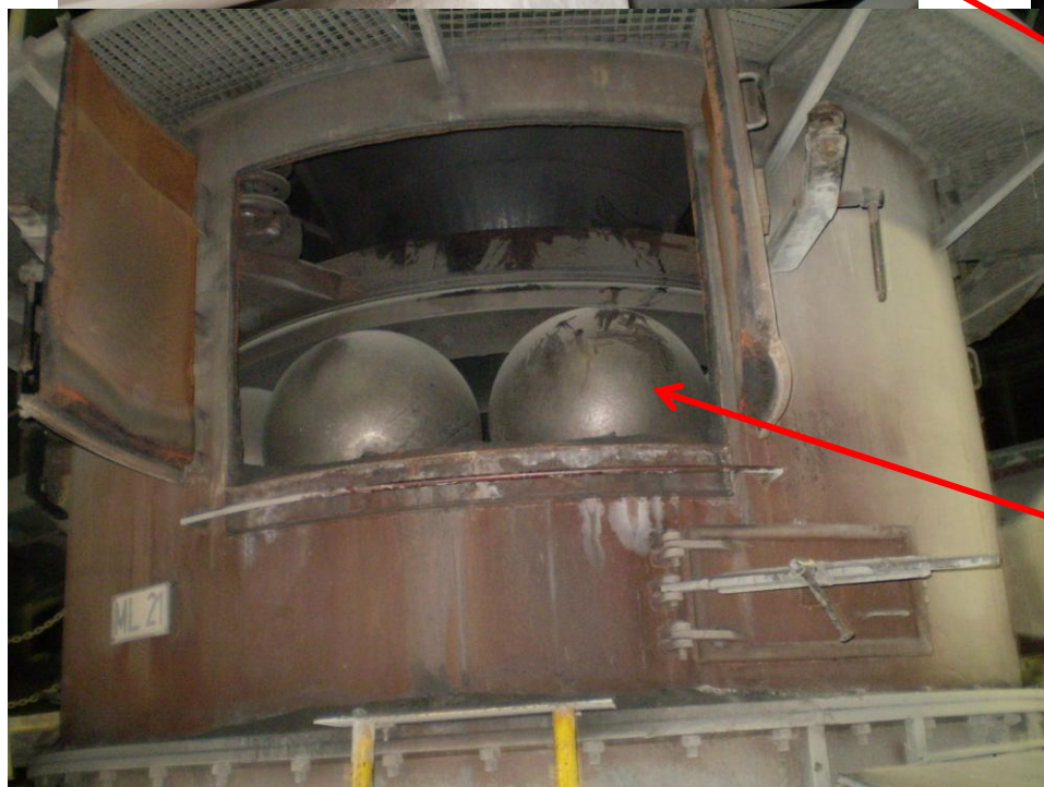
Detail kulového mlýna, uhlí se rozdrtí na jemný prach
