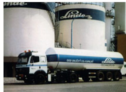
Zásobníky pro uskladňování a autocisterna pro přepravu zkapalněných plynů
