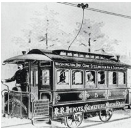
Leo Daft do motoru své první tramvaje v New Jersey přiváděl proud vozíčkem, poježdícím po dvou drátech trolejového vedení
