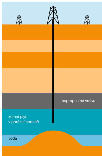
Podzemní skladování zemního plynu ve zvodnělých vrstvách
