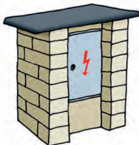
Distribuční rozváděč nízkého napětí
