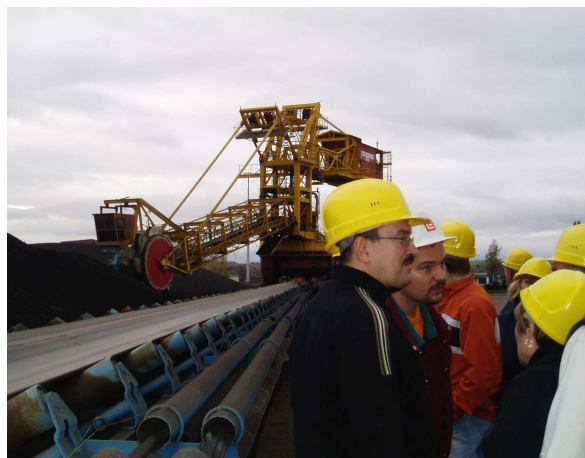
Účastníci setkání si prohlížejí pásový dopravník přivádějící uhlí do Elektrárny Počerady
