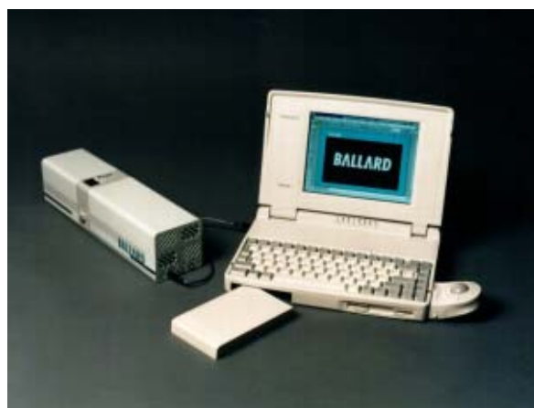
Obr. 6-16 Notebook napájený PEMFC (Ballard) [37]
