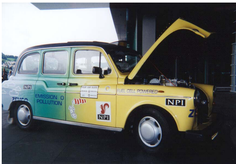
Obr. 6-5 AFC poháněný automobil (ZevCo)
