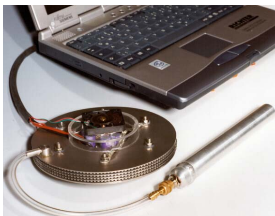
Obr. 6-17 Notebook napájený PEMFC (Fraunhoferinstitut) [37]
