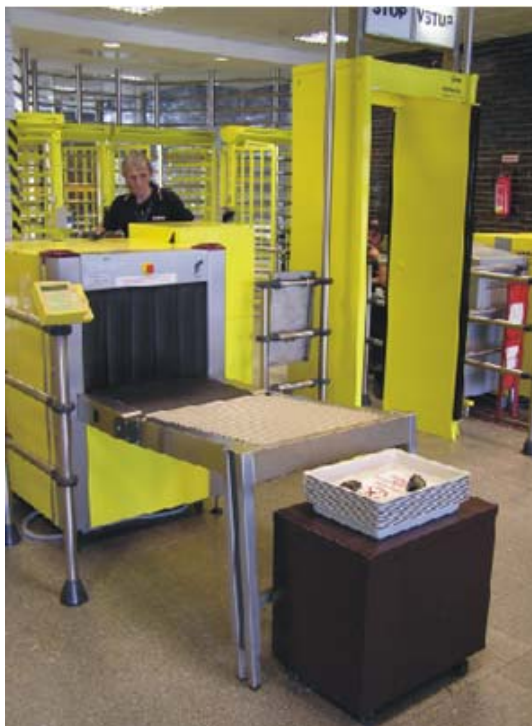
11. Rámový detektor kovů (vpravo), rentgenový přístroj na kontrolu zavazadel a drobných předmětů (vlevo)
