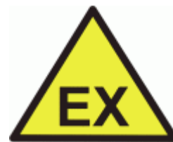
Nebezpečí- výbušné prostředí
