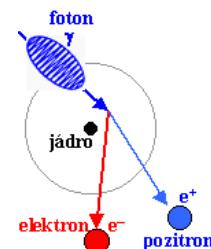
Proces tvorby elektron-pozitronových párů se nejvíce uplatňuje při vysokých energiích záření  $\gamma$  a u látek s vysokým protonovým (atomovým) číslem.
