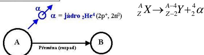
Dceřiná jádra po  $\alpha$ -rozpadu bývají často rovněž radioaktivní ( $\alpha$  či  $\beta$ ), zpravidla tvoří celé radioaktivní řady. Kromě toho jsou dceřiná jádra po  $\alpha$ -rozpadu většinou v excitovaném stavu, takže jejich deexcitace je doprovázena zářením gama.
