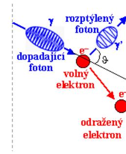
Pravděpodobnost Comptonova rozptylu roste s hustotou terčových elektronů v látce, tedy s hmotnostní hustotou látky a protonovým číslem  $Z$ . Naopak klesá s rostoucí energií fotonů. Comptonův rozptyl se relativně nejvíce uplatňuje u záření  $\gamma$  středních a vyšších energií a v látkách s nízkým protonovým číslem  $Z$  (voda, tkán).
