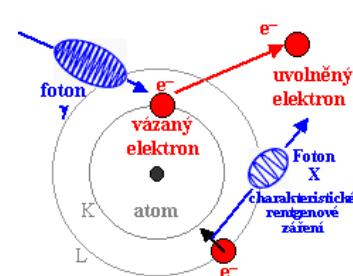
Na místo "uprázdněné" po elektronu, který vyletěl fotoefektem, okamžitě přeskočí z vyšší slupky v atomovém obalu elektron, přičemž energetický rozdíl vazbové energie na vyšší a nižší slupce se vyzáří ve formě fotonu elektromagnetického záření, znamená to, že se vyzáří se charakteristické rentgenové záření.
