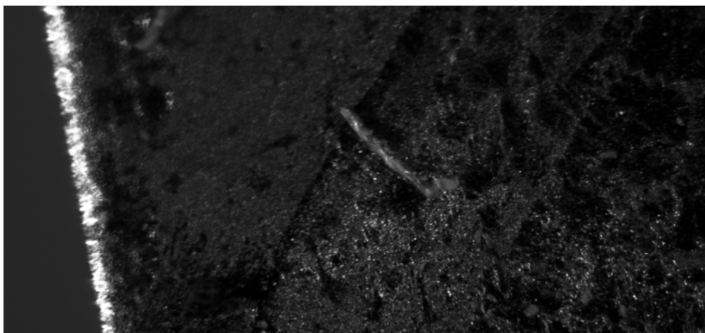
Obr. 5.6 Plocha vzorku P 6, pájka Sn99Cu1 (84 000 cyklů)
