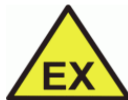
Nebezpečí – výbušné prostředí
