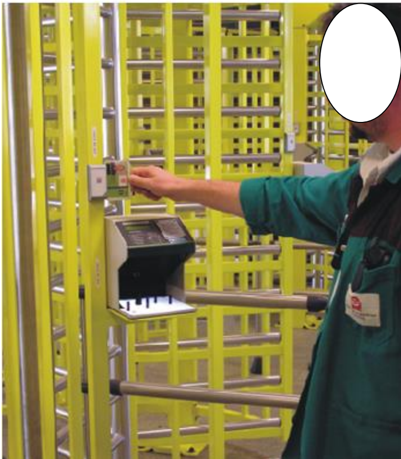
Způsob načítání karty do čtecího zařízení turniketu (přiložit bokem, pohled na zelené světlo)
