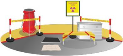
Sanitární uzel je soubor technických prostředků instalovaný na pracovišti pro snížení rizika rozšířování radioaktivní kontaminace (ohraničení, označení, dekontaminační prostředky, prostor pro oblékání/odkládání doplňkových OOP, apod.).
