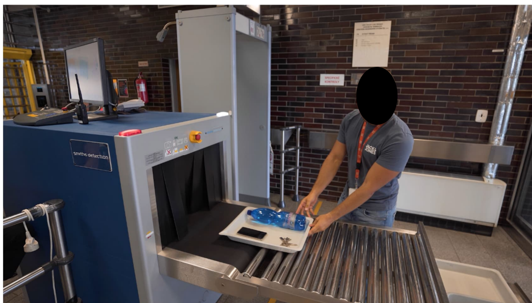
Obrázek 5.14: Způsob vkládání drobných předmětů do rentgenového přístroje
