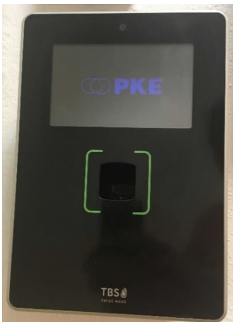
Obrázek 5.15: Biometrický snímač otisku prstu ETE
