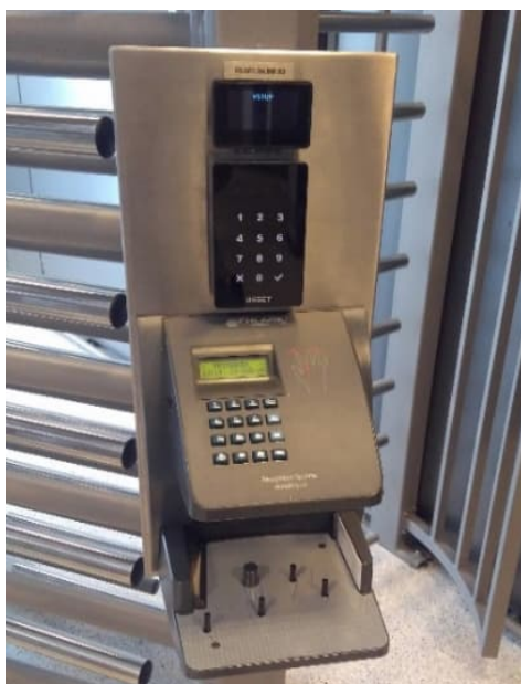
Obrázek 5.16: Biometrický snímač hřbetu ruky EDU
