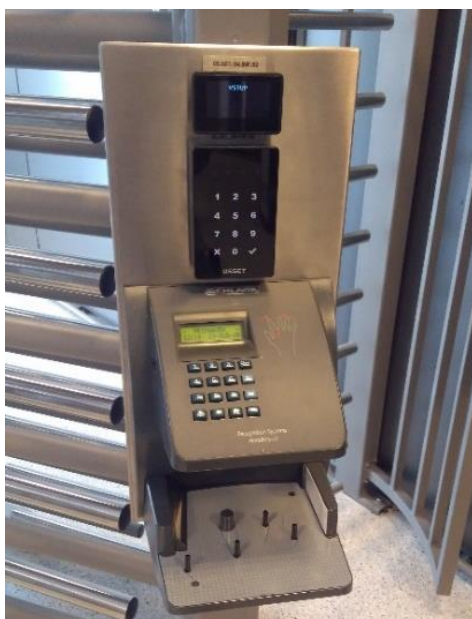
Obrázek 5.16: Biometrický snímač hřbetu ruky EDU
